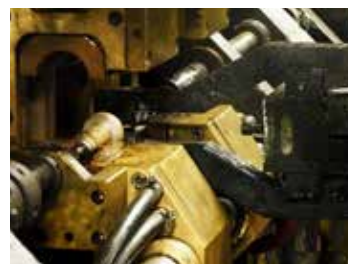
El vástago se calienta eléctricamente y se empuja para crear el collarín de empuje
