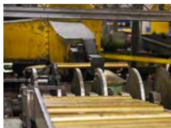
Las barras se cortan en la longitud deseada
